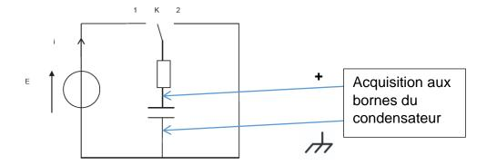
Charge position 1 ou 2 ? Charge en position 1 (il faut un générateur) Décharge position 1 ou 2 ? Décharge en position 2 (pas de générateur) Schématiser les branchements vers l'interface d'acquisition.
