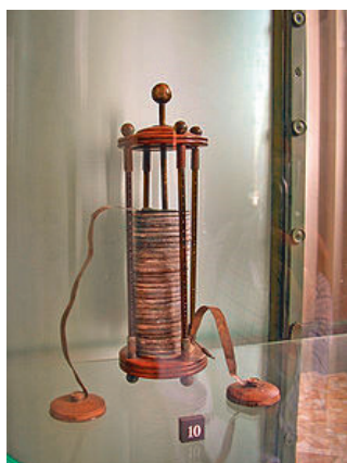
Figure 1. Photographie d'une pile Volta Source : Wikipédia
