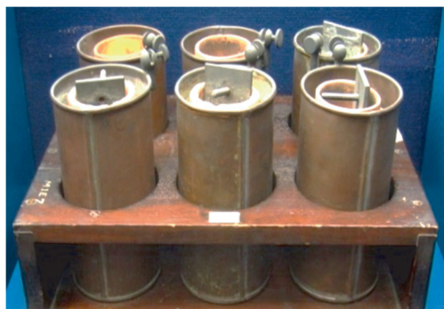
Figure 5. Photographie d'une batterie de piles Daniell
