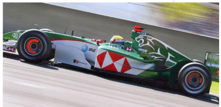
a Échauffement de la jante d'une roue de voiture de course après un freinage intense.
