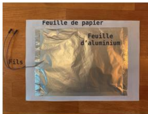
Figure 2. Photographie d'une face du capteur de pression capacitif « artisanal »
