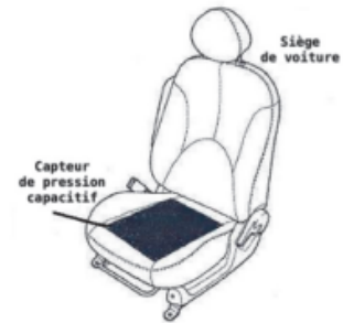
Figure 1. Schéma de l'installation d'un capteur capacitif dans l'assise d'un siège de voiture
